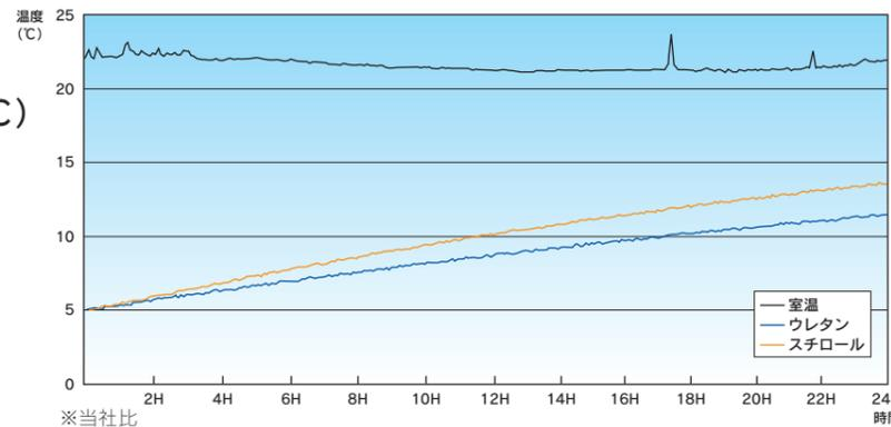
ウレタン、スチロール各容器に1800gの氷ブロックを入れフタを閉じ、室温30℃の室内に24時間放置。24時間後に残氷量を量ったところ、スチロール容器では480g、**ウレタン容器では720gの残氷量が確認されました。**
